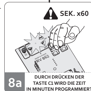
Abb. 6. Der Wechsel des Betriebsmodus des Kanals C1 zum monostabilen Modus.
