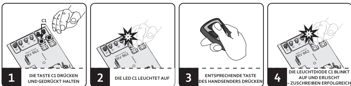
Abb. 2. Die Taste des Handsenders im Funkempfänger RIVAL 862 zum ersten Kanal C1 programmieren.
