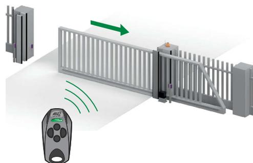
Der Kunde, der sich im Funkbereich befindet, aktiviert mit den Tasten des Senders automatisches Einlernen dieses Senders zum Funkempfänger. Ab jetzt ist dieser Sender aktiv
